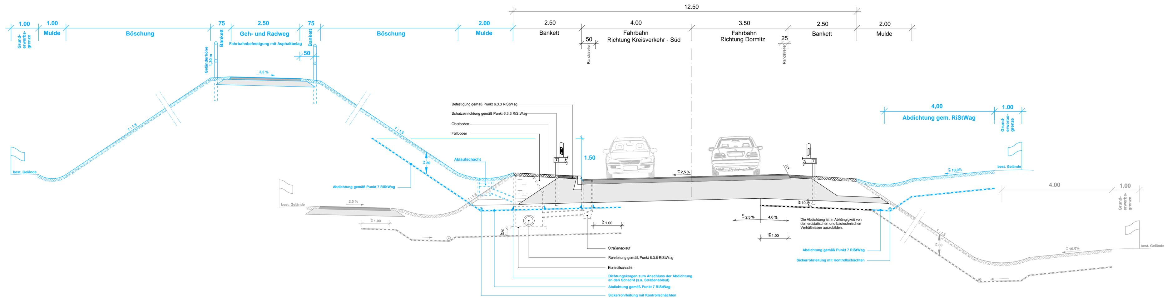
Fahrbahn der befestigten Straßenverkehrsfläche mit lärminderndem Asphaltbelag ( $D_{StrO} = -2 \text{ dB(A)}$ )
